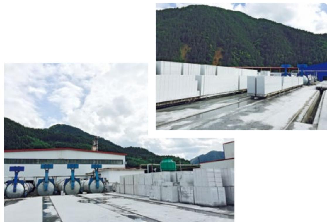
甘肃天水李子子公司利用尾矿制砖项目，推进循环经济，年生产5000万块蒸压标砖，年消耗尾矿10万吨。从源头上减少尾矿渣对环境造成的污染隐患，同时缓建、少建尾矿库减少尾矿库占用土地面积，变废为宝，创造良好的经济效益和社会效益。
