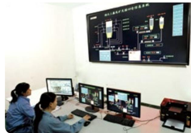
湖北三鑫公司、江西金山公司井下采用尾砂胶结充填采矿工艺，利用浮选尾矿经过旋流器分级后的粗粒级尾砂进入充填砂仓，用于井下充填，每年可利用约40万吨尾矿砂充填采空区，减少了尾矿的排放，缓解了尾矿库存压力。图为湖北三鑫公司尾砂充填系统控制室。
