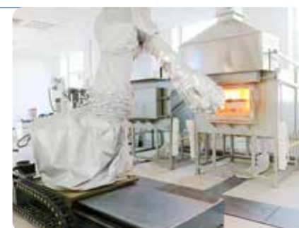
自主研发火试金自动化检测系统
