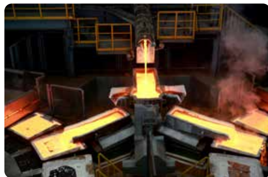
河南中原冶炼厂圆盘浇铸生产现场
